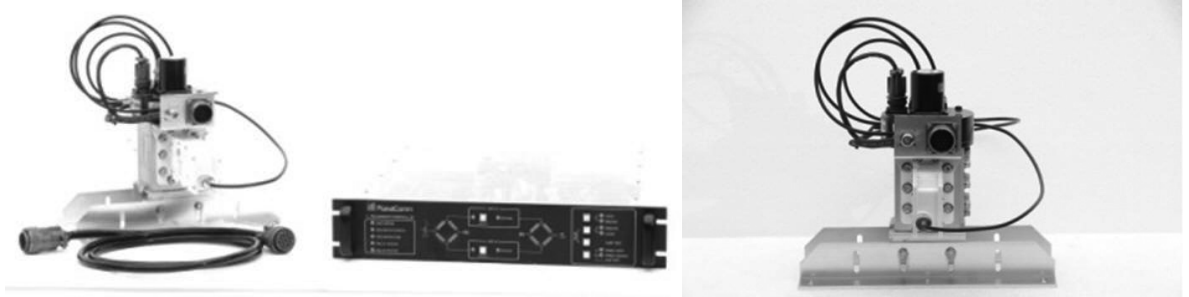
ภาพแสดงอุปกรณ์ควบคุมการสำรองการทำงานของภาครับสัญญาณดาวเทียม
